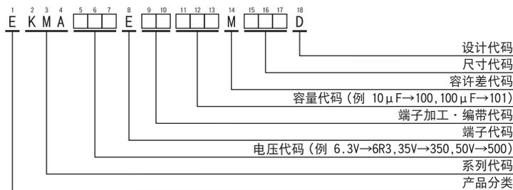
产品型号代码的详细介绍请参考「产品型号的表示方法(引线型)」。
